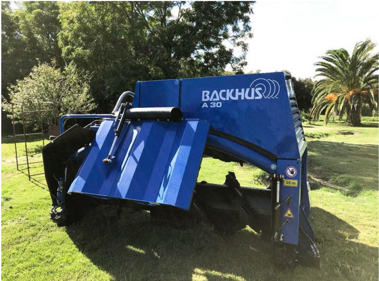
La trampilla hidráulica posterior permite una óptima formación de la pila y controlar el material que se lanza
